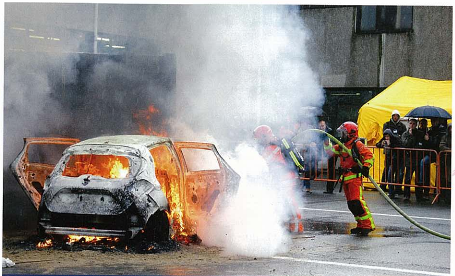
L'équipe de SOLDATS DU FEU magazine est la seule à proposer aux sapeurs-pompiers français des démonstrations en phase avec les questions du moment. Comme ici, lors du brûlage d'une Renault Zoé, permettant ainsi aux spectateurs d'assister à l'emballement de la batterie de la voiture, comme cela est décrit dans le Rescue guide de la firme au losange. ©XAVIER SCHEPMAN
